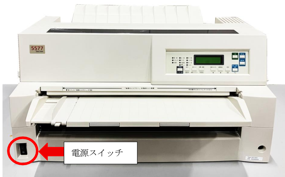
写真1: プリンター全体と電源スイッチの位置
